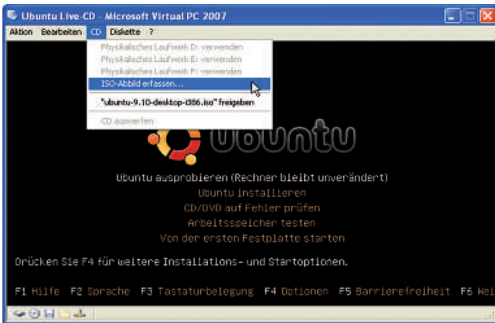
Microsoft Virtual PC 2007: Ein Klick auf CD, ISO-Abbild erfassen... startet einen virtuellen Rechner vom Abbild einer bootfähigen CD oder DVD (Bild C).
